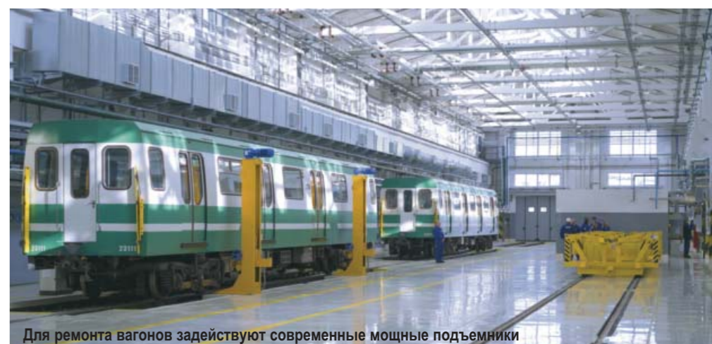
Для ремонта вагонов задействуют современные мощные подъемники
