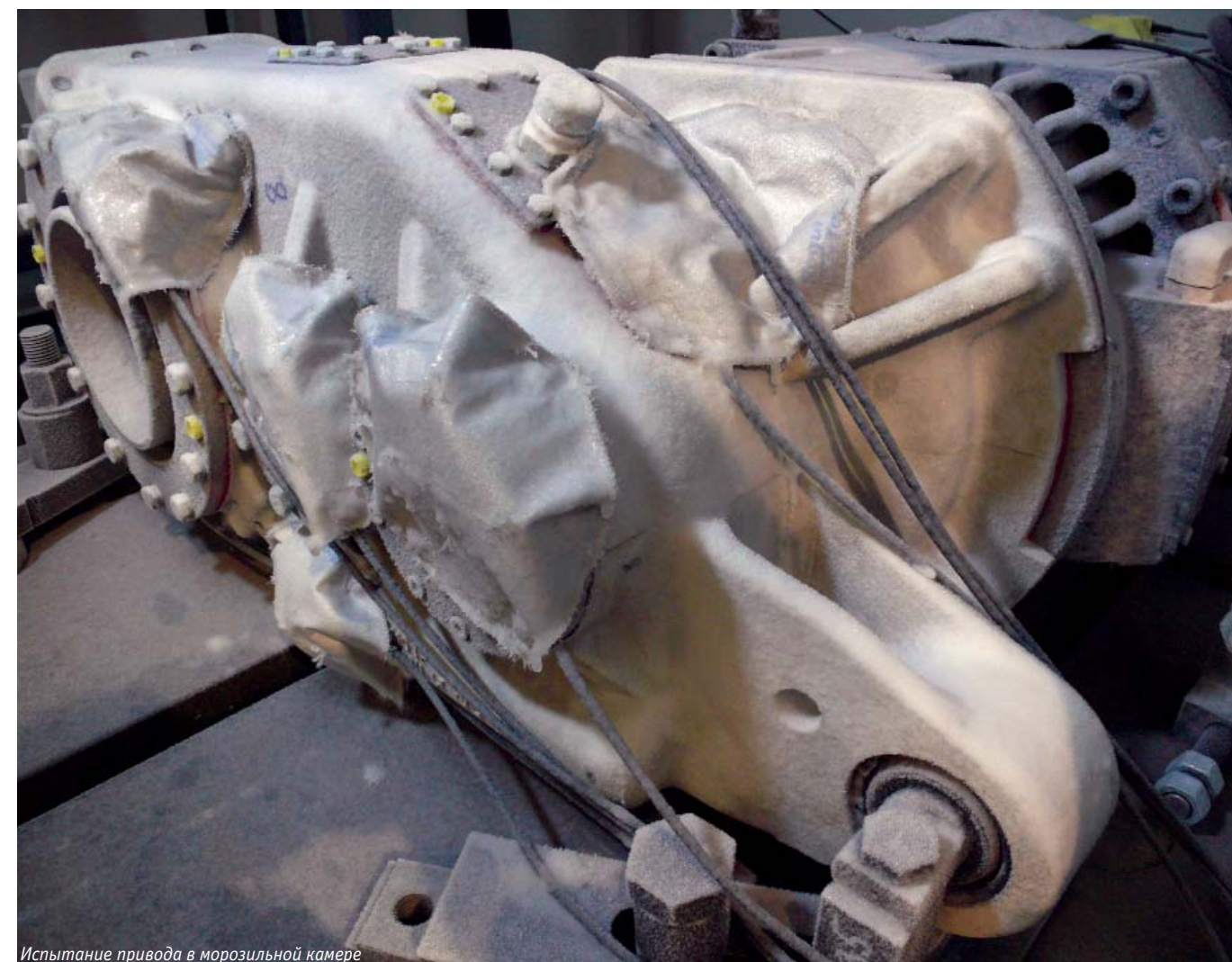
Испытание привода в морозильной камере
