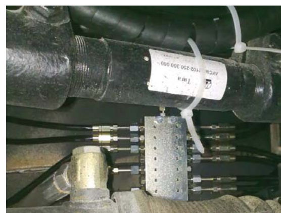
Один распределитель PVB со специальным покрытием управляет раздачей и дозировкой смазки в опоры переднего моста и рулевой колонки
