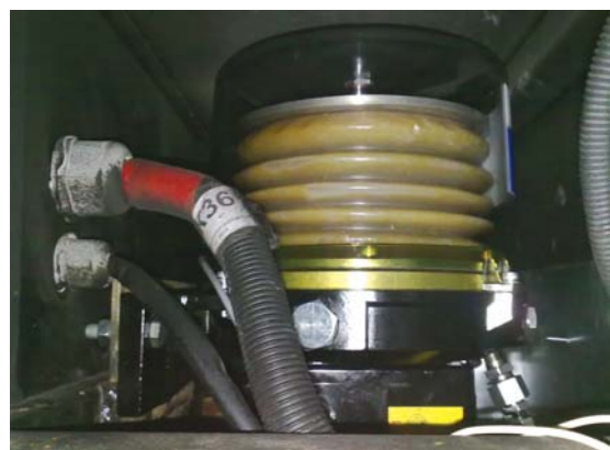
Смазочный насос установлен в специальной нише под полом троллейбуса. Кнопка контроля и принудительного запуска насоса монтируется в кабине
