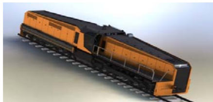
Вариант модернизации тепловозов с электропередачей ТЭМ-2 и ТЭМ-7 (предлагается инновационный вариант специального исполнения с тёплым кузовом, эргономичной кабиной и системой постоянного прогрева системы охлаждения и системы смазки)
