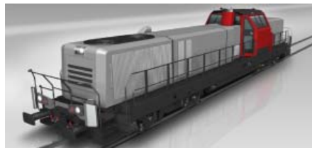
Вариант модернизации тепловозов с электропередачей ТЭМ-2 и ТЭМ-7 (предлагается инновационный вариант специального исполнения с тёплым кузовом, эргономичной кабиной и системой постоянного прогрева системы охлаждения и системы смазки)
