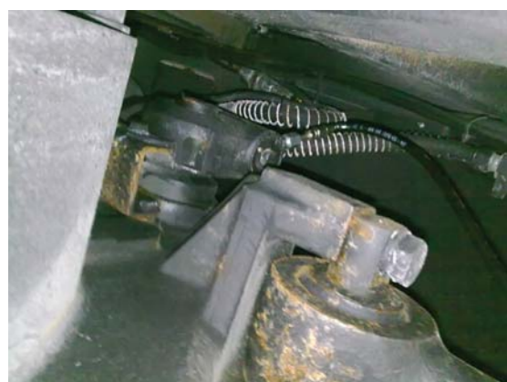
Подвод смазки в передний мост производства ZF. Гибкий трубопровод подобран и собран по месту монтажа
